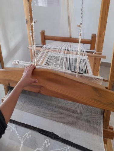
Fotoğraf 12. Dokuma işlemi, mekik masura ve çımbar, Fotoğraf: Dilek Tüm Cebeci, Dastarhane, 2025.
