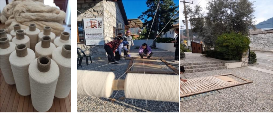
Fotoğraf 7. Kullanılan iplikler ve çözgü ipliklerinin hazırlanması çivilerden oluşan ahşap düzenek, Fotoğraf: Dilek Tüm Cebeci, Dastarhane, 2024.
