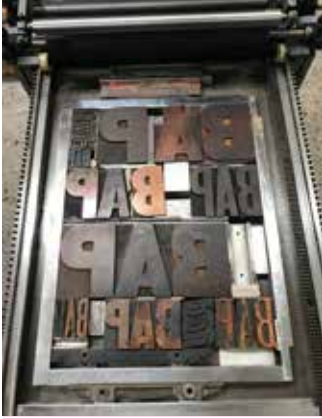
PROVA TEZGAHINDA AHŞAP VE METAL HARFLERLE DİZİLMİŞ HURUFAT KALIBI.
